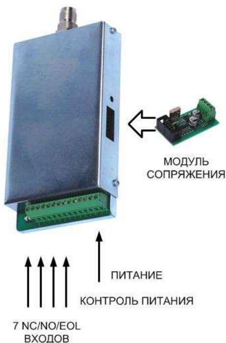
Рис.3. Общая схема соединений передатчика
